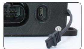
密封的外壳和-40至+85°C的工作温度范围适用于车辆，包括热/冷天气测试
