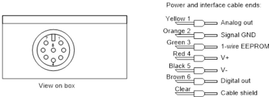
Bild 7: PTCM Buchse für Systemkabel
